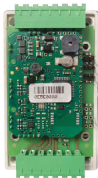
SYSTEM BUS ■ JA KLIDOVÝ STAV LINKY (A) ■ J0 ZAKONČENÍ LINKY ■ JB KLIDOVÝ STAV LINKY (B)
